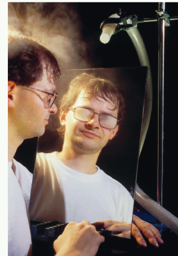
Spiegel mit Anti-Beschlag- Nanobeschichtung
