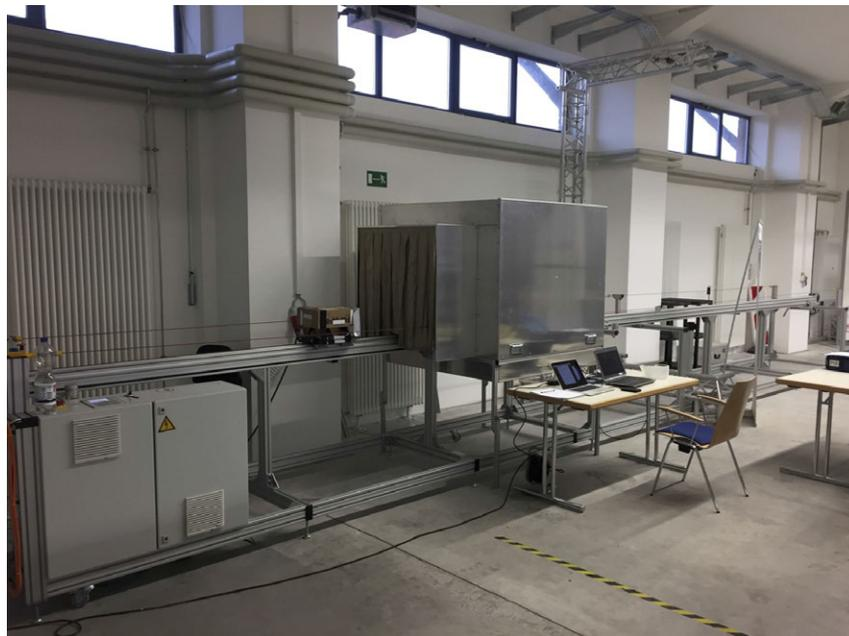
Abbildung 3.28: Tunnelgate und Linearförderer zur Optimierung der Lese- und Erkennungsrate von RFID-Tags
