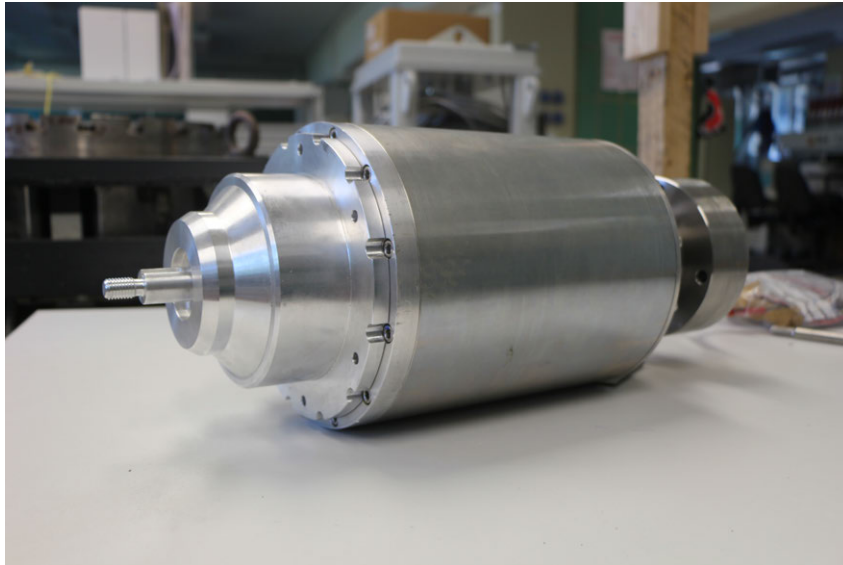
Abbildung 3.11: Generator für die hydrokinetische Turbine
