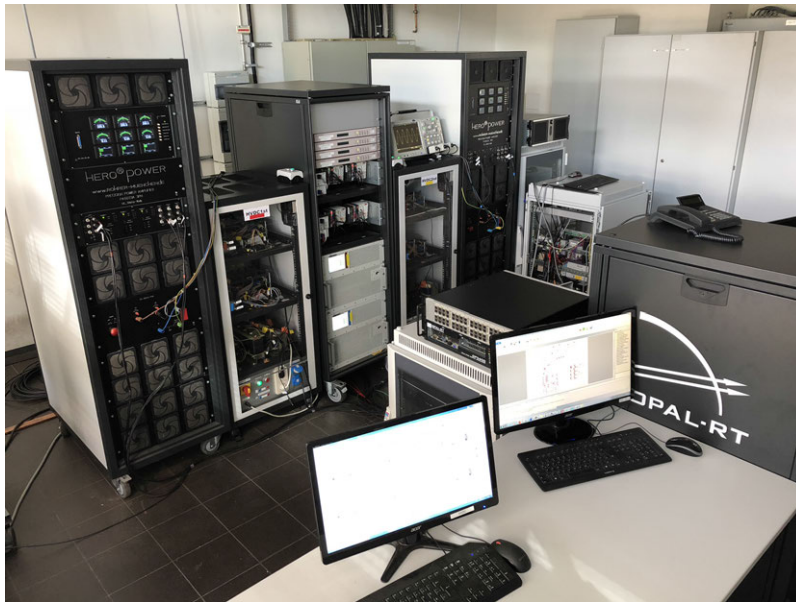
Abbildung 3.19: DGCC-Netzsimulator am Standort Magdeburg
