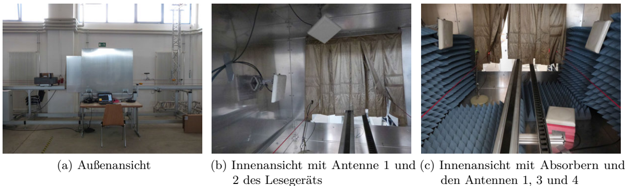
Abbildung 3.37: Aufbau des Linearförderers und des RFID-Tunnelgates
