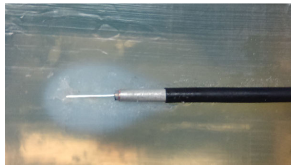
(b) Ablation im gepulsten Betrieb
