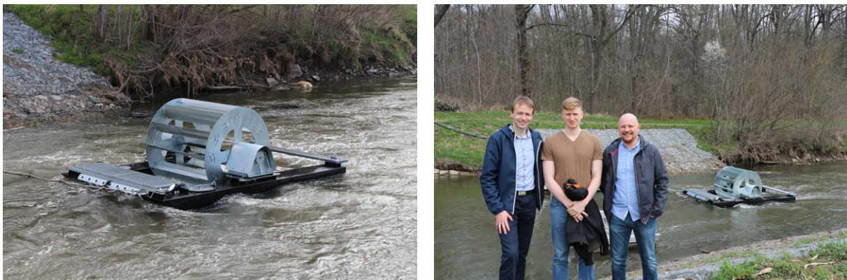
Abbildung 3.10: Wasserrad mit geteiltem Generator auf der Bode in Neugattersleben
